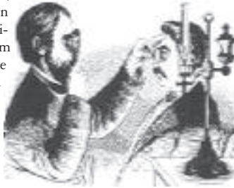
Um dos primeiros oftalmoscópios indiretos, com a imagem invertida iluminada pela luz de uma lâmpada na mesa
